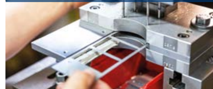
Spezialwerkzeuge für genaue Stanz- und Locharbeiten
