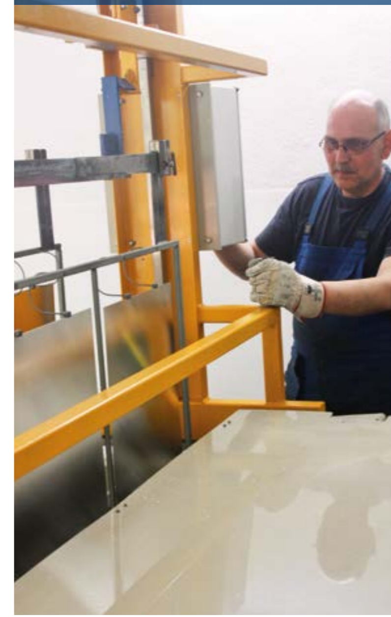
Eloxieren und Verdichten von Aluminiumplatten im eigenen Haus.
